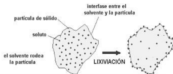
Modelo esquemático del proceso de lixiviación
